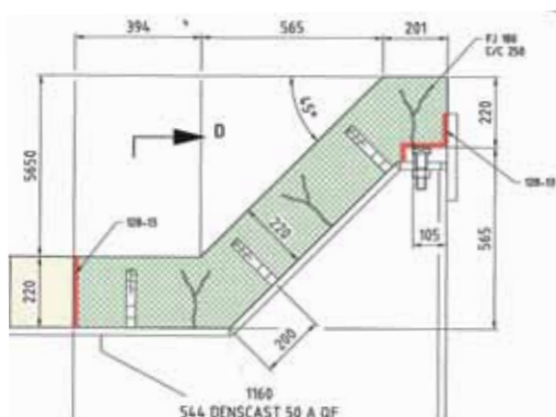
Входной конус – литые огнеупоры
